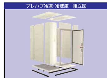
プレハブ冷凍・冷蔵庫 スリムセパレートタイプ
